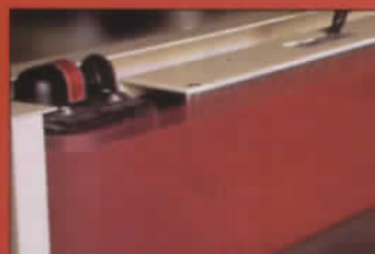
ベルトオッシレーション ベルトが上下に振動しながら回転するので、研磨面の温度上昇や焼き付きを抑えることができます。
