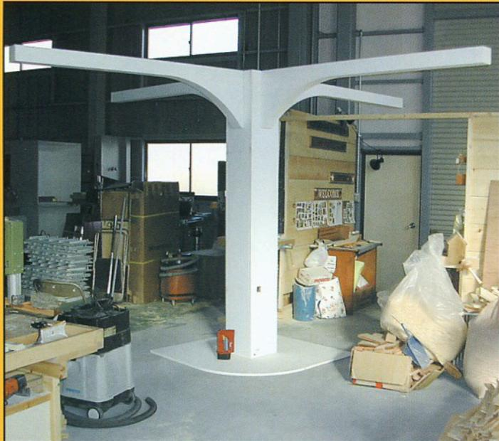
上記の写真のように大型のディスプレーにも使用できます。36組のインビスで組み上がっていますのでバラバラにして輸送できます。1本のはりは4組のインビスで取り付けてあります。強度は充分です。
