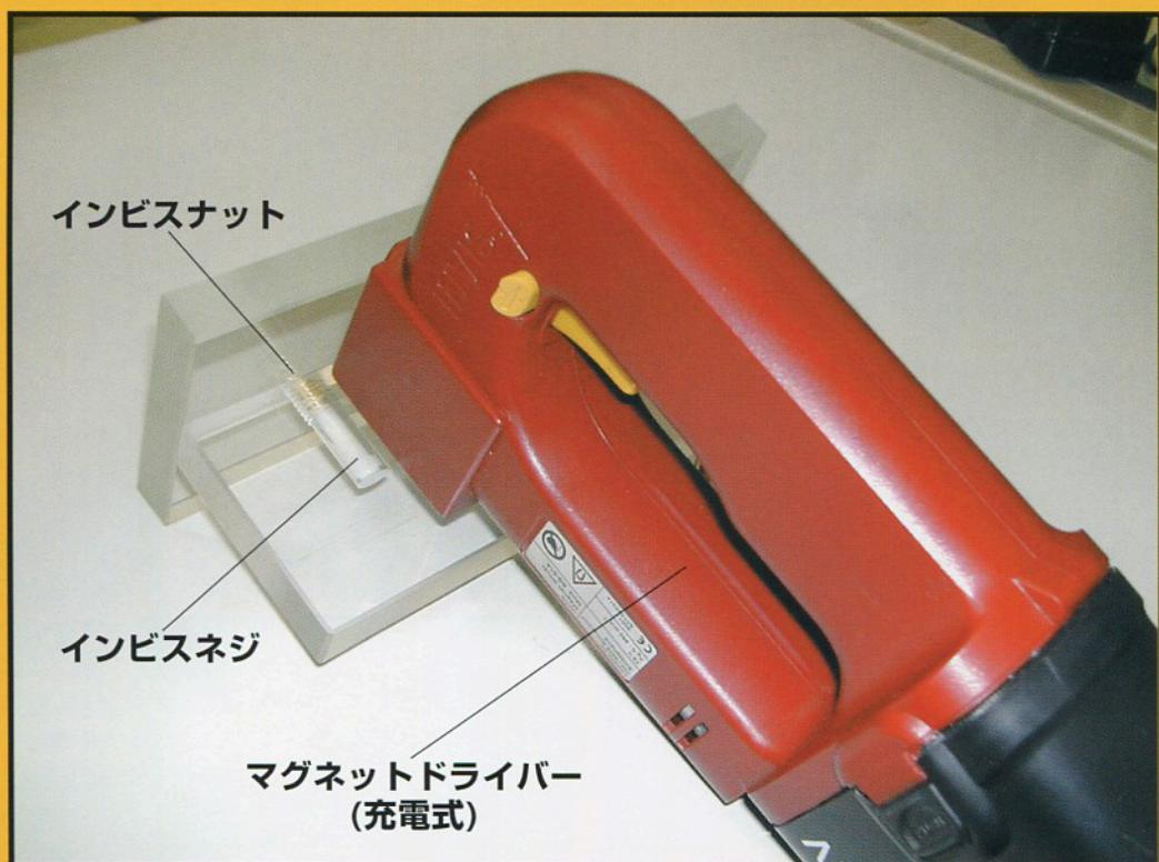
2枚の板をT形継ぎやL形継ぎ、平継ぎする場合には一方の板にインビスネジ(小さな永久磁石とインパクト機構が内蔵されたネジ)をねじ込み、もう一方の板にインビスナットをねじ込み、板を組みます。マグネットドライバー(強力な永久磁石が回転するドライバー)を板の外側から当てスイッチを入れるとインビスネジの中の永久磁石が回転磁界により回転します。それによって、ネジに回転と打撃トルクを与えながら、ネジをインビスナットに締結させます。上の写真は透明なアクリル板を結合させてるのでインビスが見えていますが、木材の場合には全く見えません。マグネットドライバーを逆転させますとネジをゆるめることができます。
