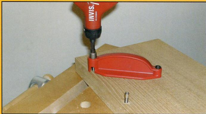
インビスナットの下穴にインビスナットを軽くねじ込み、ねじ込みガイドを当ててください。専用のドライバービットをラチェットハンドルに装着してインビスナットをねじ込みます。ねじ込みガイドを使用しないとインビスナットを接合面に対して垂直にねじ込むことができません。インビスナットの頭部の下面が接合面
