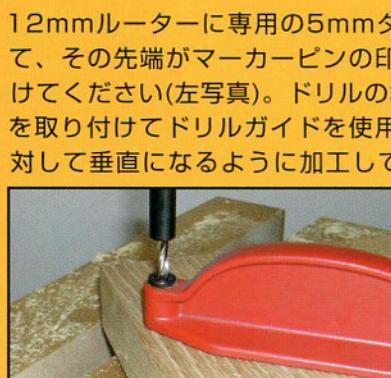
12mmルーターに専用の5mmダボビット(別売)を取り付けて、その先端がマーカーピンの印に来るようにして下穴をあけてください(左写真)。ドリルの場合には5mm木工用ドリルを取り付けてドリルガイドを使用して下穴の方向が接合面に対して垂直になるように加工してください(右写真)。下穴の有効深さは12mmインビスでは14mmに、8mmインビスでは10mmにしてください。
