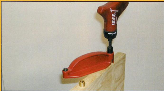
インビスネジの下穴にインビスネジを差し込んで、ねじ込みガイドを当ててください。専用のドライバービットをラチェットハンドルに装着してインビスネジをねじ込みます。ねじ込みガイドを使用しないとインビスネジを接合面に対して垂直にねじ込むことができません。インビスネジの頭部が接合面から0.2~0.5mm
