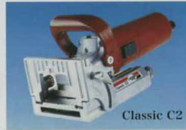
ワンタッチでフロントベース+ベースプレートが外せるので、プレートの交換や内部の清掃が容易にできます。
